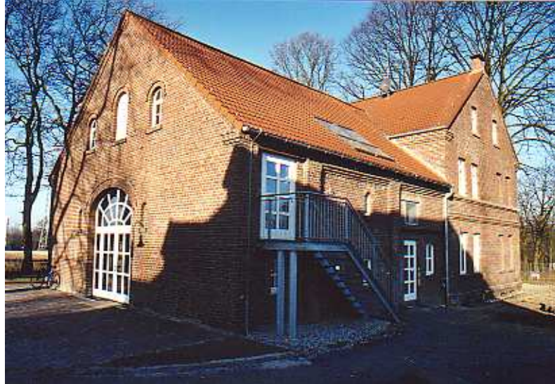
Das Haupthaus steht in vollem Glanz, gesandstrahlt und vollständig neu verfugt, mit neuen Fenstern und Türen – und dem zweiten Rettungsweg vom Seminarraum nach draußen.
